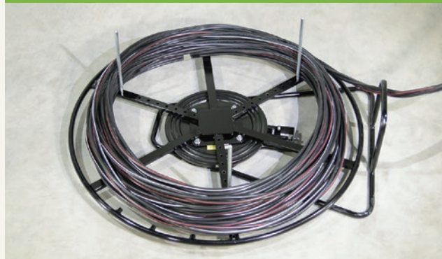
ケーブル束の送出し
